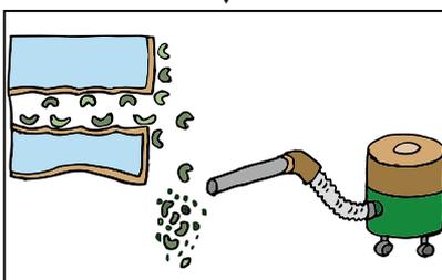
4. 加熱後、スス・被覆硫黄分が崩れ落ちたものは電気掃除機等で吸取り、完了です。
