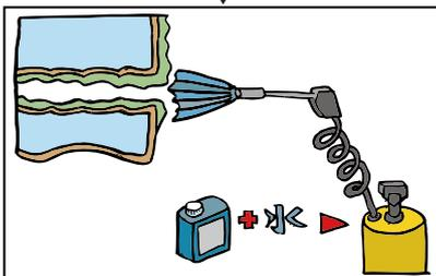
2. 汚れに応じて水で10～20倍に薄めて、スプレーヤーでボイラの燃焼室や煙管内の壁にスプレーし、10～15分待ちます。
